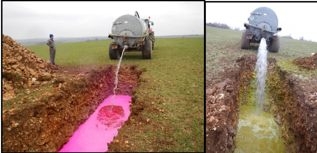
Figure 3 : Injection de sulforhodamine B (à gauche) et d'uranine (à droite)
